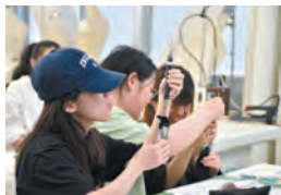
パネばかりによる接着プレスの剥離強度テスト
